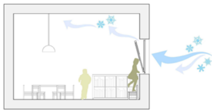
Figura 2 Desenho ilustrativo do impacto da ventilação na zona de ocupação – Janela basculante (Azevedo, 2012).
